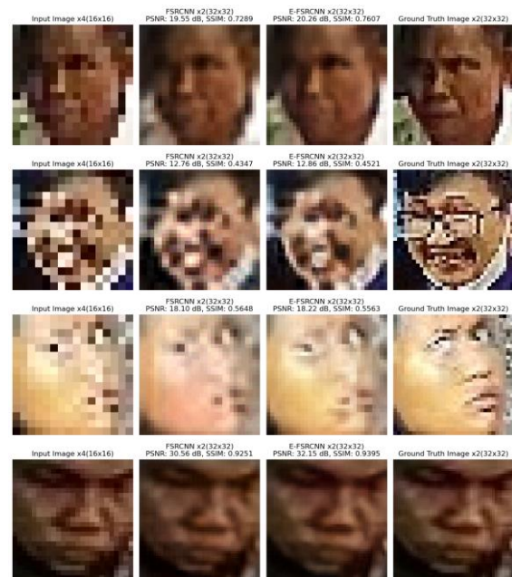
Gambar 8. Hasil rekonstruksi Dataset CCTV FSRCNN dan E-FSRCNN (x4 ke x2)
