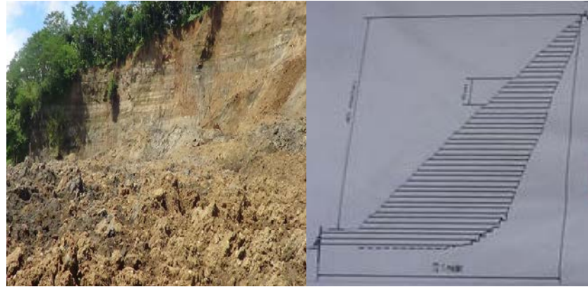
Gambar 7. Kondisi bagian dasar Tebing dan Sketsa Bidang Longsor pada Lokasi Sumber: Dokumentasi, 2015, Kementerian PUPR, 2015
