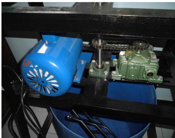
Gambar 5. Alat mixer pembuat sabun susu tampak atas
