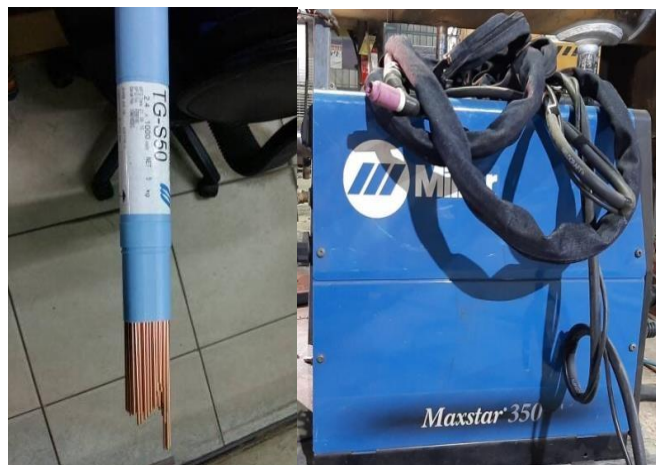
Gambar 6. Elektroda dan gambar mesin las GTAW.
