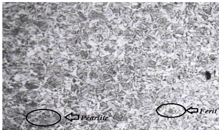
Gambar 9. Struktur mikro pada based metal perbesaran 50\ \mu\text{m} .
