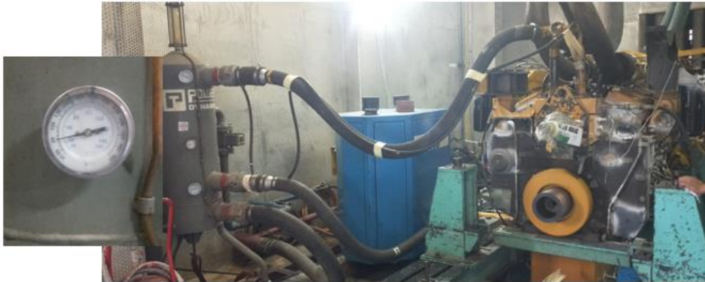
Gambar 8. Pengetesan engine dengan temperatur input 40°C.
