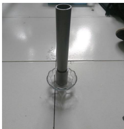
Gambar 3. Posisi pipa saat pengukuran kecepatan air
