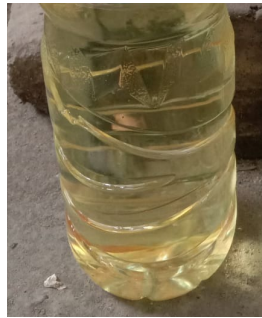
Gambar 3. Air yang terbawa oleh tabung penyimpan dan terjebak di dalam separator (sumber : document pribadi).
