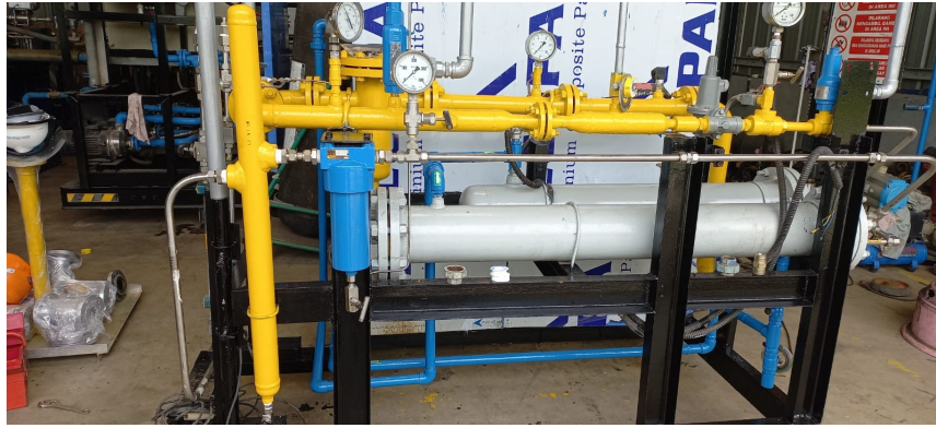
Gambar 8. Separator terpasang lengkap di mesin (sumber : document pribadi)
