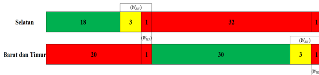
Gambar 3. Diagram waktu sinyal 2 fase
