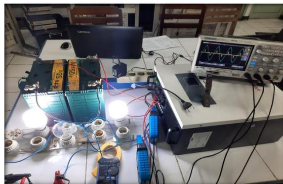
Gambar 9. Rangkaian keseluruhan
