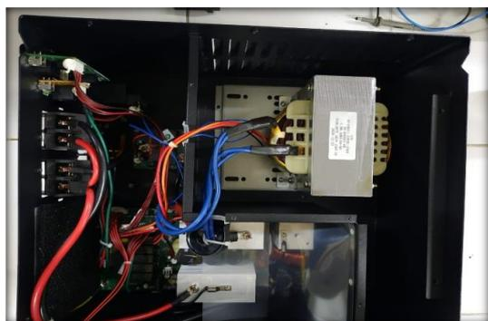
Gambar 7. Isi modul kenika (*charger controller* dan *inverter*)
