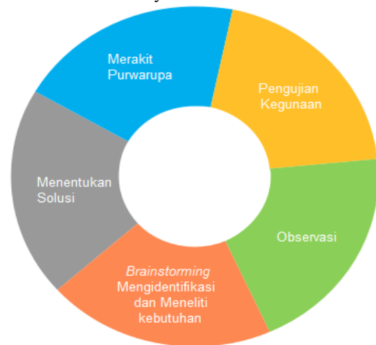
Gambar 5. Tahapan pada Engineering Design Process dengan pendekatan Design Thinking dari Stanford Design School
