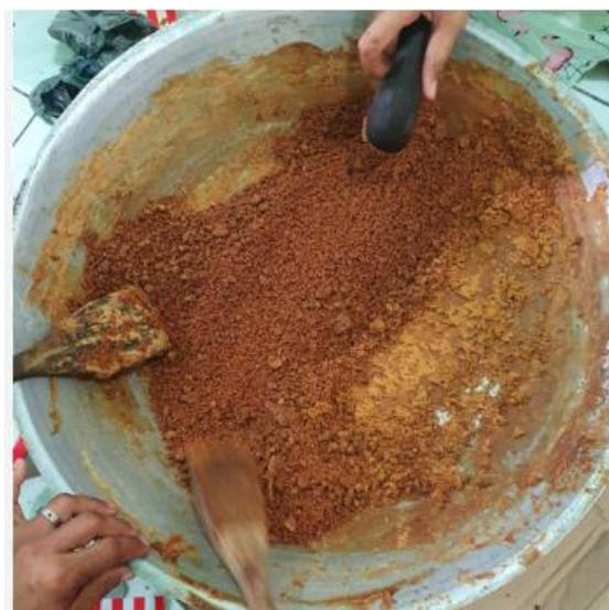
**Gambar 3.** Proses Pengoyakan Gula Rajang Sebelum Menggunakan Mesin
