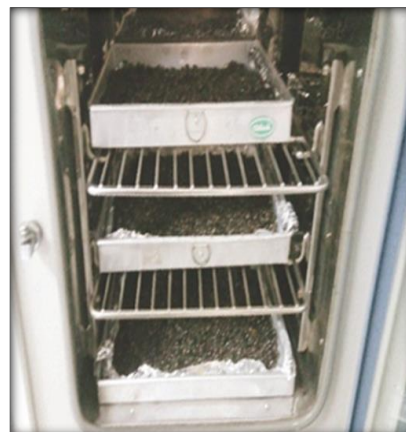
Gambar 2. Cara Pengeringan Biji Pepaya dalam oven suhu 50°C
