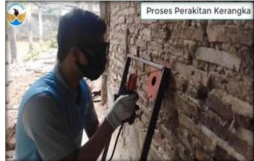
Gambar 5. perakitan kerangka peniris minyak
