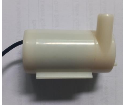
Gambar 8. Pengecekan terhadap Pompa DC
