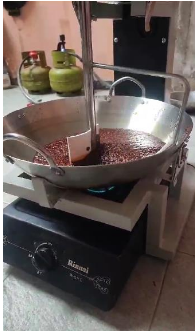
Gambar 5. Pengaduk sambal otomatis telah diaplikasikan
