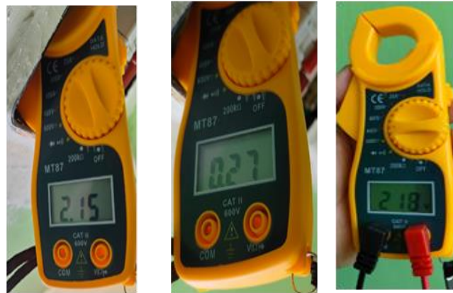
Arus grup 1 = 2,15 A grup 2 = 0,27 A tegangan 218 volt
