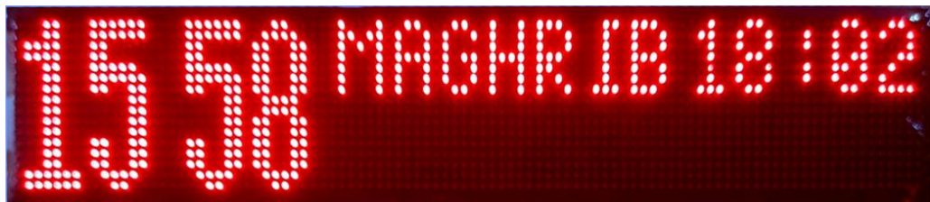
Gambar 3. Sistem Penampil Jadwal Sholat Digital menggunakan display dot matrix P10
