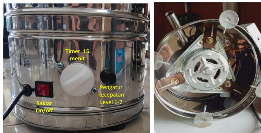
Gambar 6. Sistem kontrol kecepatan dan rangka motor induksi
