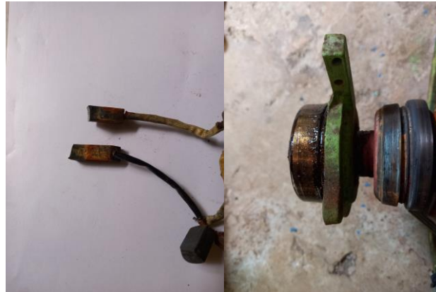
Gambar 3. Carbon brush dan slip ring eksisting
