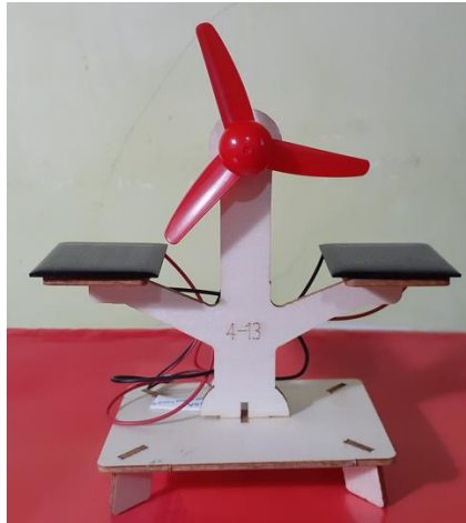
Gambar 7. Alat peraga PLTS dengan beban kipas.
