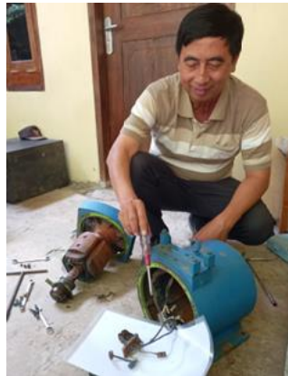
Gambar 6. Pemeliharaan komponen internal generator.
