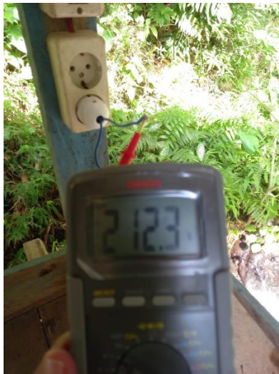
Gambar 7. Tegangan generator dengan beban 25 titik lampu
