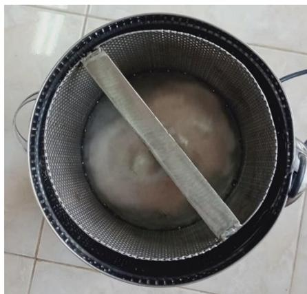
Gambar 3. Bagian Dalam Drum Mesin Peniris Minyak
