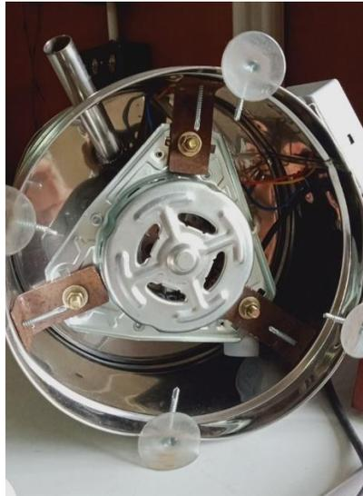
Gambar 4. Motor Listrik Mesin Peniris Minyak
