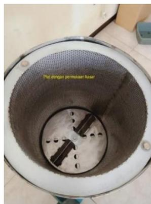
Gambar 4. Bagian dalam Drum Mesin Pengupas
