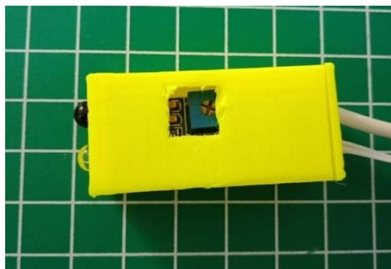
Gambar 10. Pembuatan Rumah Sensor Infra Merah Proximity
