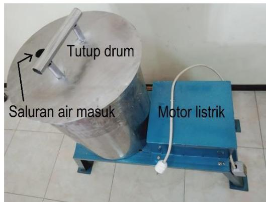
Gambar 3. Tampilan mesin pengupas
