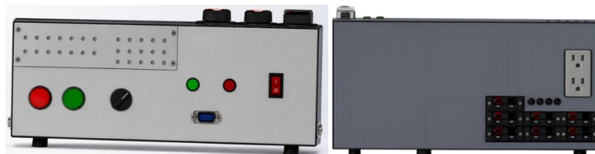
Gambar 4. Desain 3D Alat Rancang Bangun Inspeksi Kabel Tampak Depan dan Tampak Atas.
