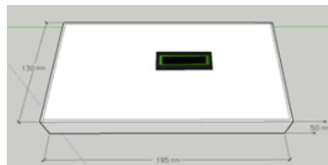
Gambar 3. Dimensi Kotak Penempatan *Hardware*
