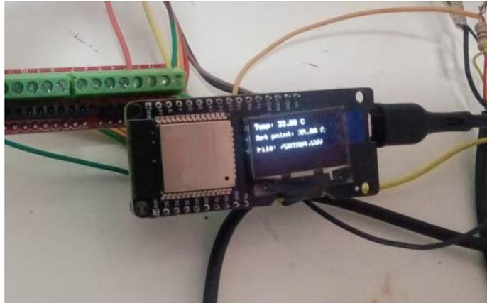
Gambar 6. Contoh Tampilan pada OLED
