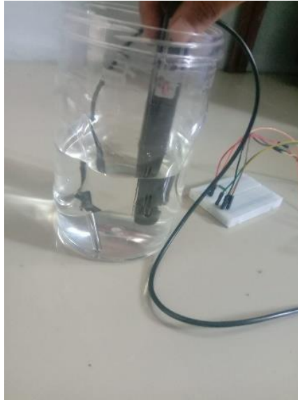
Gambar 4. Pengujian sensor suhu DS18B20
