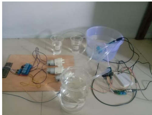
Gambar 1. Hasil instalasi Esp32 dengan komponen pendukung
