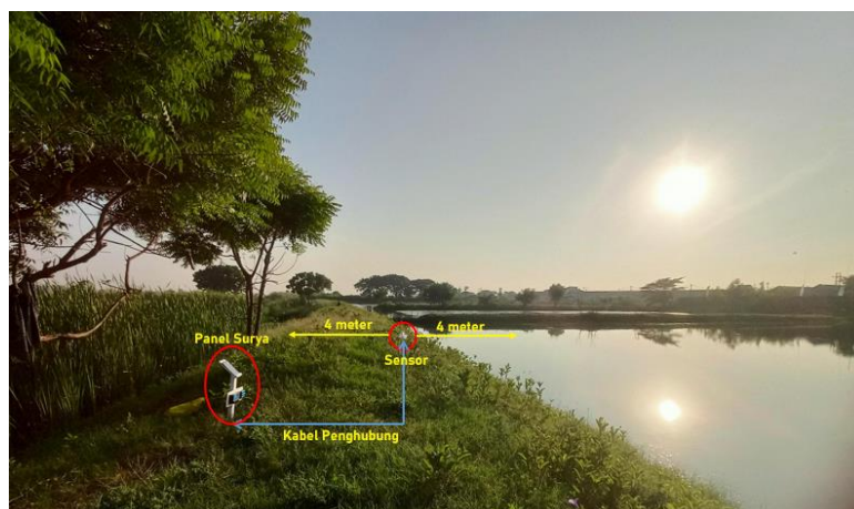
Gambar 10. Pengujian Alat di Tambak
