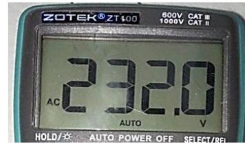
Gambar 7. Tegangan luaran *inverter* PSW
