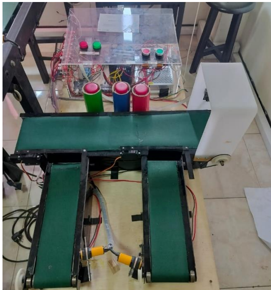
Gambar 3. Sistem Mekanis dan Skematik Sistem Konveyor & Motor DC
