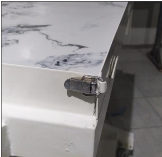
Gambar 7. Bagian Pembatas Tangan Diberi Engsel Agar Adjustable
