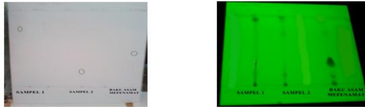
Gambar 3. Hasil kromatografi lapis tipis dengan etil asetat : metanol : ammonia diamati pada sinar tampak (kiri) dan sinar UV 254 nm (kanan).
