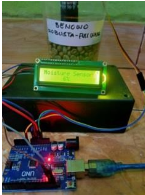
Gambar 5. Pengujian kadar air dengan Sensor CSM untuk biji kopi Benowo
