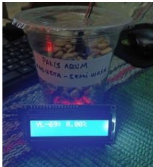
Gambar 6. Pengujian kadar air dengan Sensor YL-69 untuk biji kopi Pakisarum
