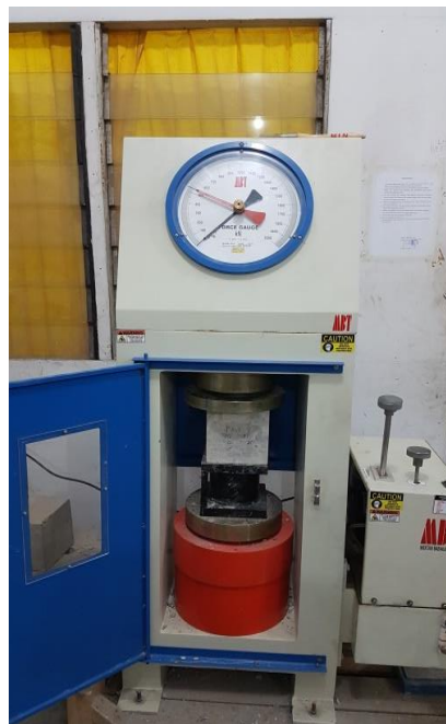
Gambar 3. Uji kuat tekan beton
