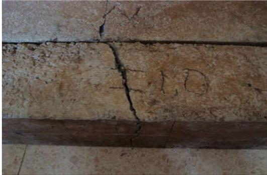
Gambar 8. Keruntuhan balok beton ringan dari ALWA dengan serat limbah karpet
