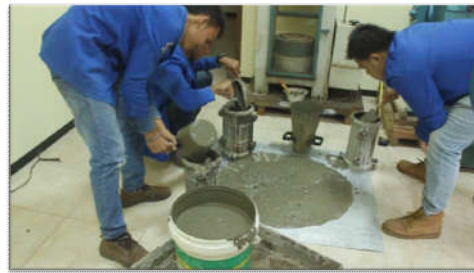
Gambar 2. Proses penuangan beton ke dalam silinder
