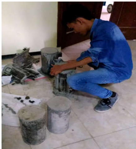
Gambar 5. Beton umur 1 hari
