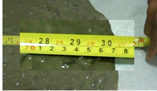
Gambar 4. Pengukuran hasil uji slump
