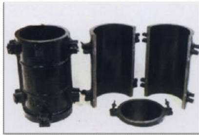
Gambar 1. Cetakan beton silinder
