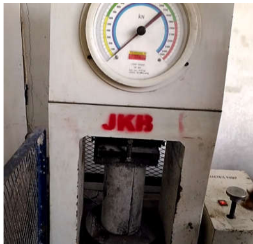
Gambar 6. Proses pengujian kuat tekan beton
