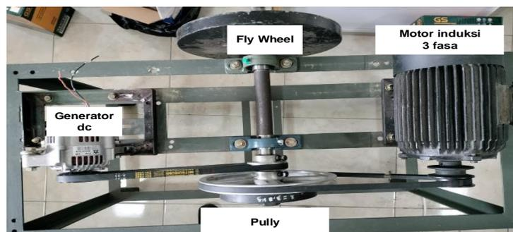
Gambar 3. Sistem Penyimpan energi Inersia Fly Wheel
