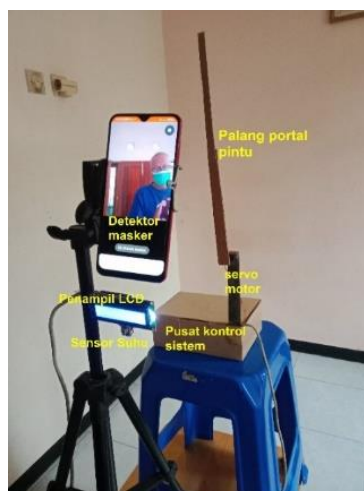
Gambar 7. Sistem portal otomatis berdasarkan deteksi masker dan suhu tubuh
