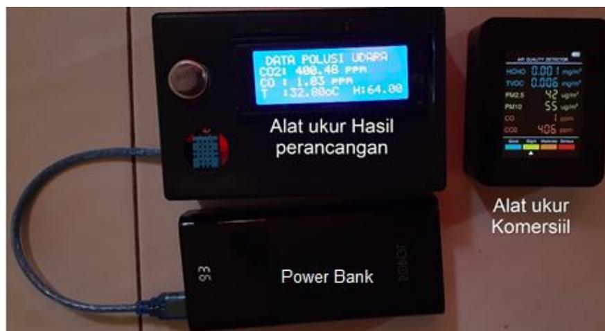
Gambar 2. Alat ukur polusi udara perancangan dan alat ukur komersial
