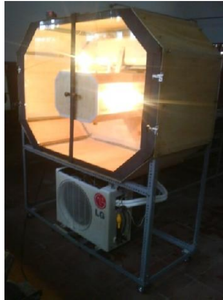
Gambar 4. Ruang instalasi uji mesin pendingin
