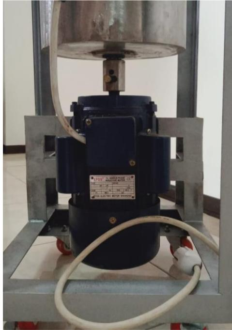
Gambar 4. Motor listrik mesin pengaduk adonan roti
