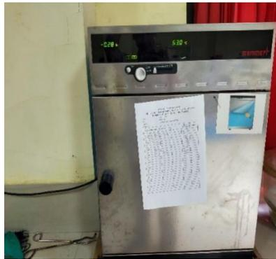
Gambar 3 Pengeringan dengan suhu  $60^\circ$
