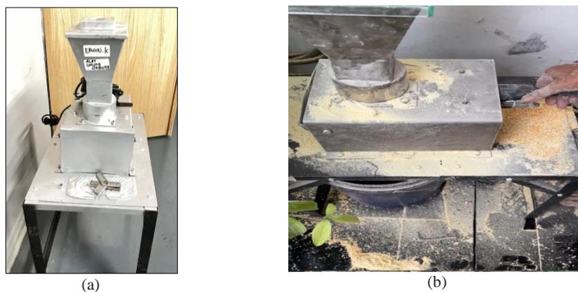
Gambar 3. (a) Prototipe mesin penggiling jagung sederhana dan (b) contoh cuplikan proses penggilingan.
